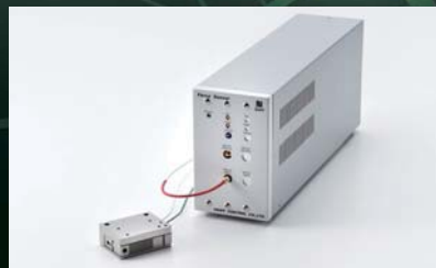
미소력 센서와의 접속 Connection with a micro force sensor
