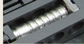
스테이지 본체에 삽입 Assembled to the body of a piezo stage
