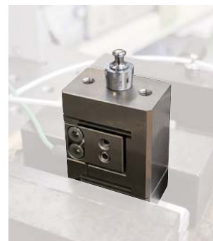
기준 분동을 놓은 감도 교정 Sensitivity calibration with reference weight
