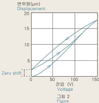
그림 2는 적층형 압전 소자에 전압을 인가했을 때의 변위량입니다. 전압에 따라 압전소자는 신축되지만 전압을 올릴 때(승압 시)와 내릴 때(강압 시)의 변위곡선은 같은 궤적을 통과하지 않습니다. 이것을 히스테리시스(이력)라고 부르며, 최대 변위량의 약 15~20%정도 발생합니다.
