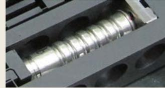
금속 케이스 봉입 타입은 압전 소자를 외기로부터 차단한 구조로 함으로써 분위기의 영향을 잘 받지 않습니다. 수지 외장 타입의 압전 소자에 비해 주위 온도나 습도에 대한 내구성이 뛰어나고 장시간 정전압 인가에서도 열화(수명)가 잘 일어나지 않아 다음과 같은 기기나 환경 혹은 사용 방법에 적합합니다.
