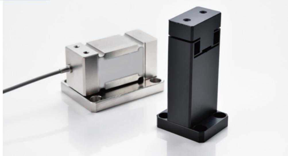
圧電素子をアクチュエータとして利用しやすい様に、コンパクトなガイド機構に組み込んだ製品です。タップ穴付きなので固定や取り外しが簡単に行え、弾性ヒンジガイドにより真直性の高い動きが得られます。変位センサは内蔵しておりません。
